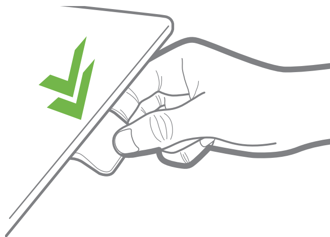
Abbildung 6 Doppeltippen Sie auf das DPI, um den Schreibtisch in eine voreingestellte Lieblingsposition zu bewegen.
